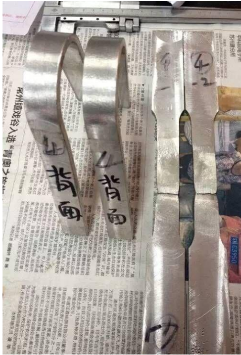
图4 弯曲、拉伸试样
