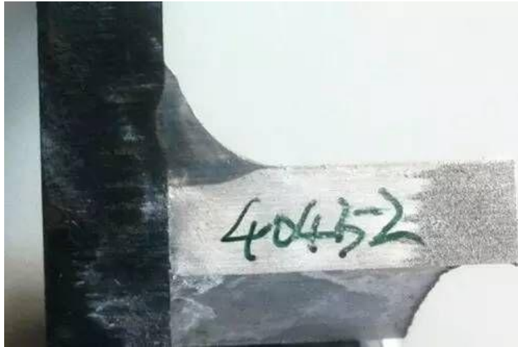
图5 管板角接熔深情况
